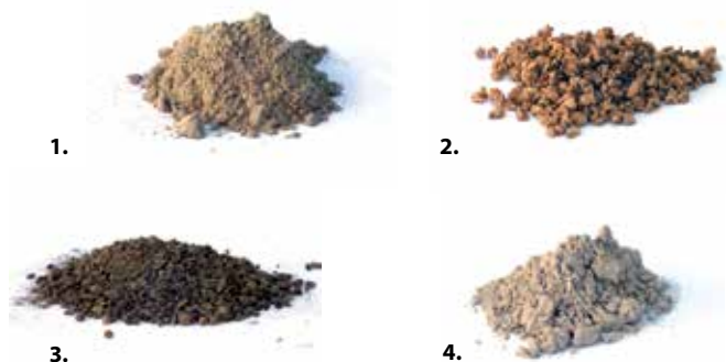
1. Poudres de diatomées / 2. Liège / 3. Argile / 4. Chaux hydraulique naturelle
